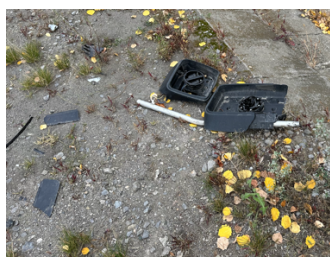
Остатъци от пътните знаци след удар с огледало на тежкотоварен камион и остатъци от огледалото на камиона.
