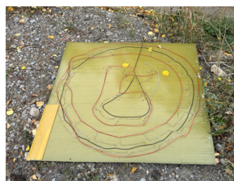
Остатъци от пътните знаци след удар с огледало на тежкотоварен камион и остатъци от огледалото на камиона.
