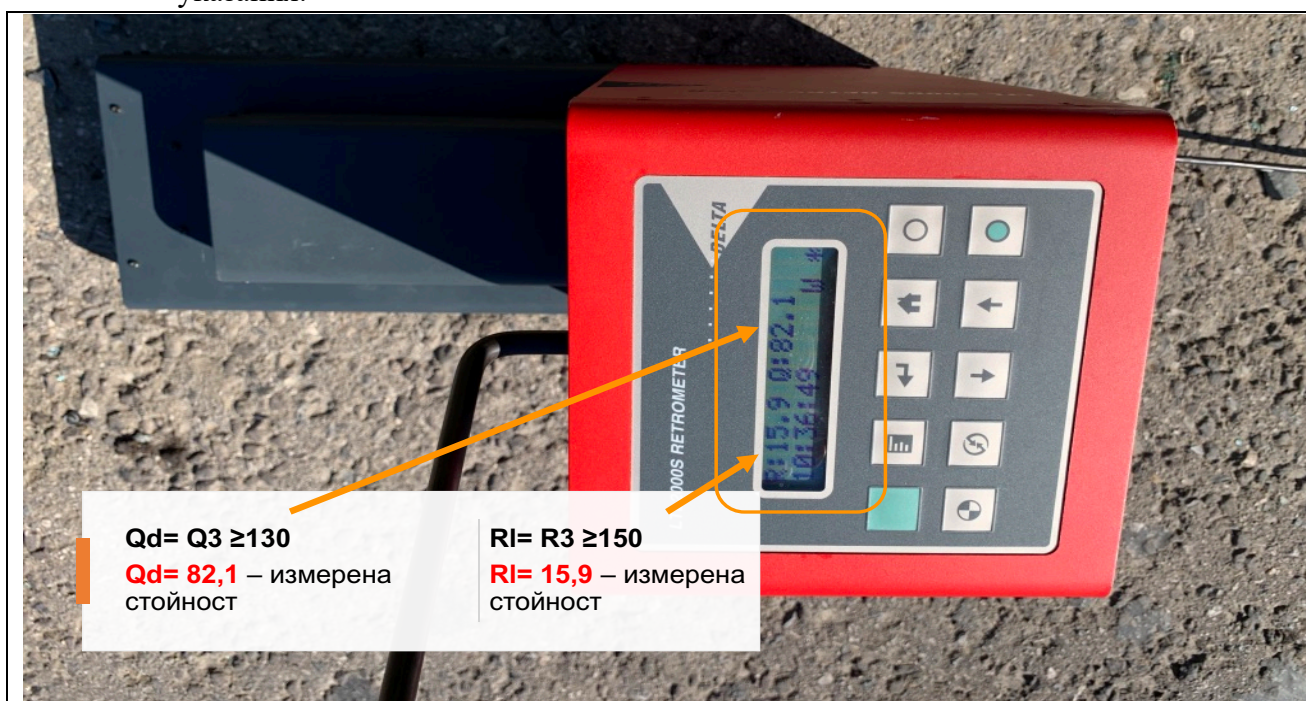
Релани измерени стойности при замерване на светлоотразителността, замерени чер сертифициран уред
